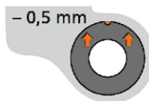
Markierung am Buchsenkragen zeigt am oberen und unteren Rahmenband nach der Verstellung nach hinten.
